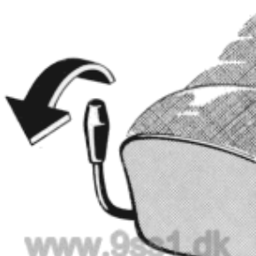
Sitze verstellen Hebel an der Sitz-Außenseite hochziehen.
