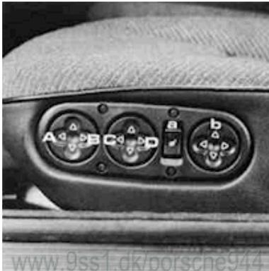
Sur les voitures équipées d'un réglage électrique des dossiers et du siège en longitudinal, deux fonctions supplémentaires ont été attribuées aux deux commutateurs à bascule placés à l'arrière.
