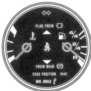
Il est recommandé à toutes les personnes assises dans la voiture de mettre les ceintures, ceci pour augmenter leur sécurité. Pour vous rappeler de mettre votre ceinture, le témoin de la ceinture de sécurité monté dans l'instrument combiné gauche s'allume dès que l'allumage est enclenché et jusqu'à ce que la languette de la ceinture de sécurité du conducteur soit introduite dans la serrure.
